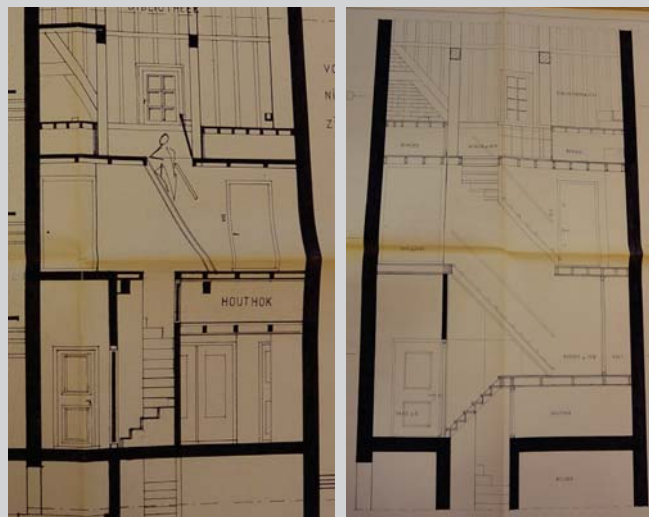
193. Doorsneden trappenhuis Oude Delft 50, 1992 bestaand en nieuw.
