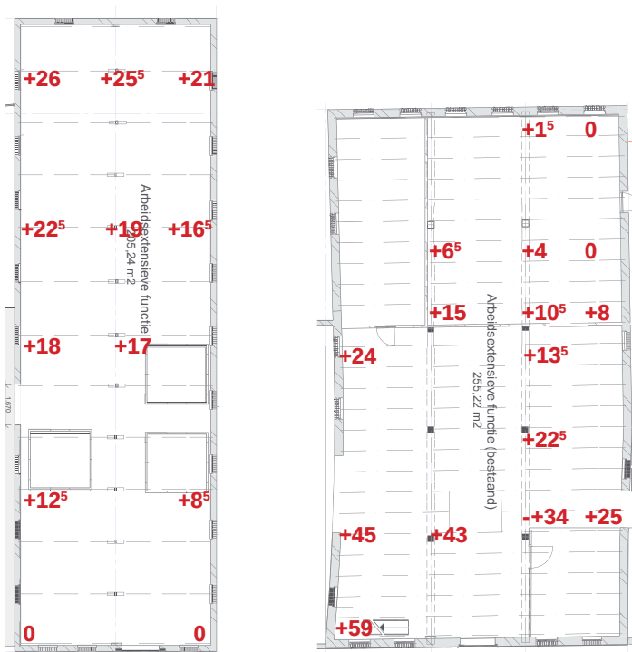
63. Zakkingen in cm, Coerland derde verdieping en Lijfland begane grond.
