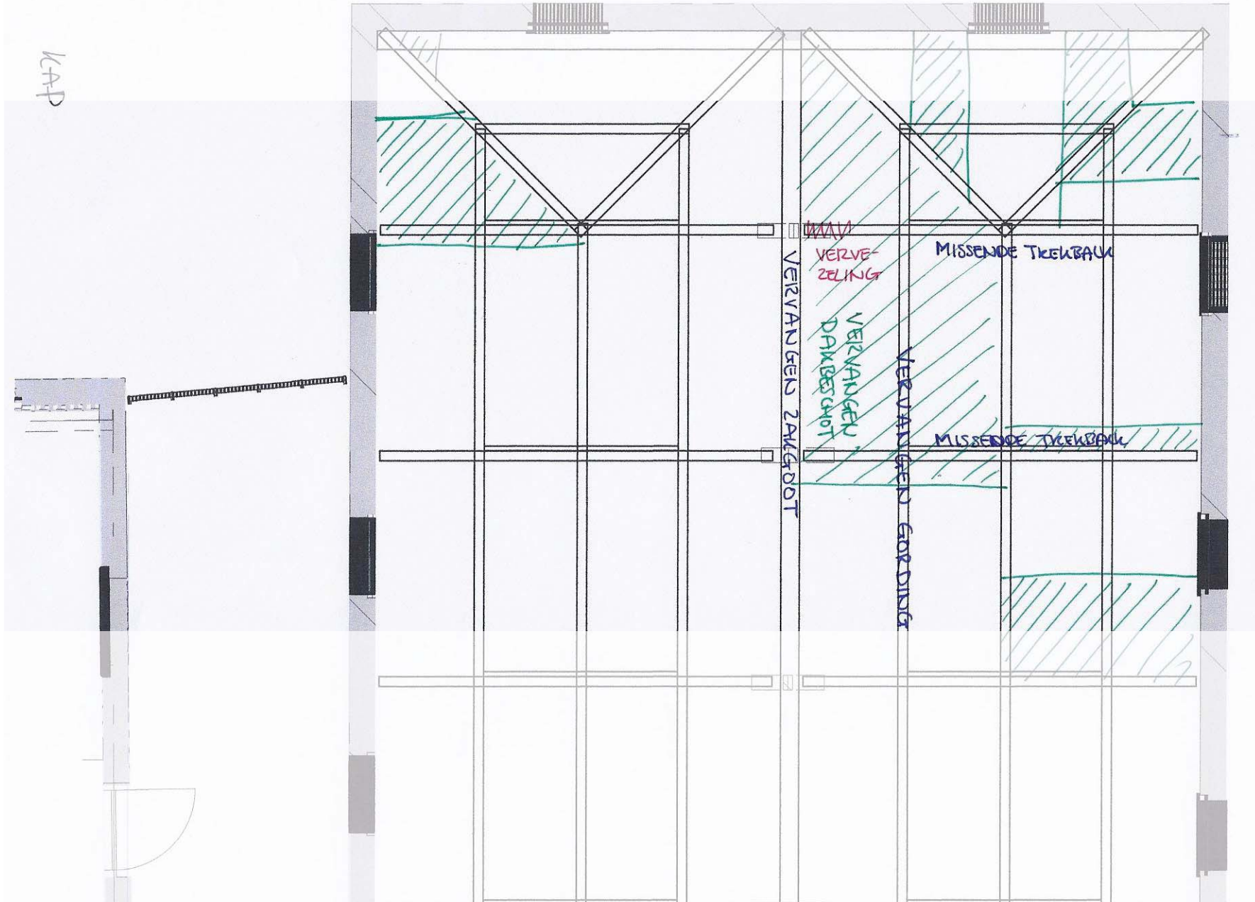
Kapconstructie met de schades daarin aangegeven, schaal 1:50.
